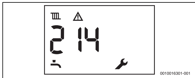
Rys. 81 Przykład: usterka niepowodująca blokady
