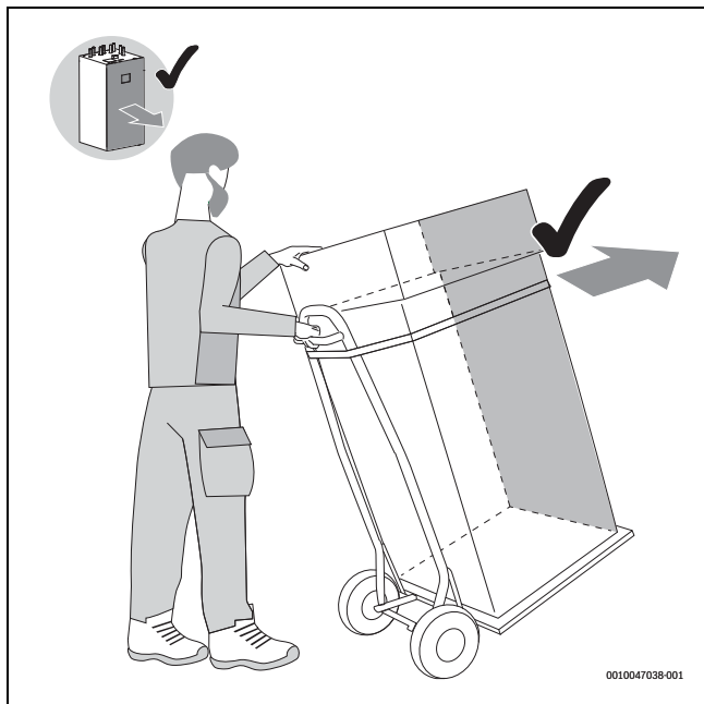
Rys. 9 Transport jednostki wewnętrznej wózkem transportowym
