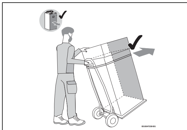
Rys. 9 Transport jednostki wewnętrznej wózkem transportowym
