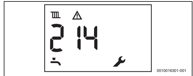
Rys. 130 Przykład: usterka niepowodująca blokady
