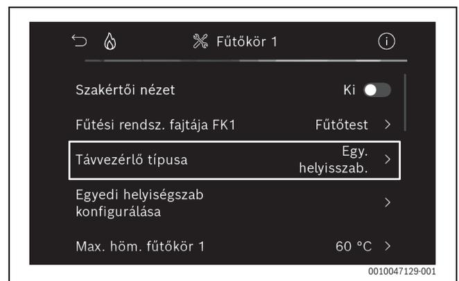
3. ábra Példa kondenzációs gázkészülék; fűtőtest helyiségenkénti szabályozás
