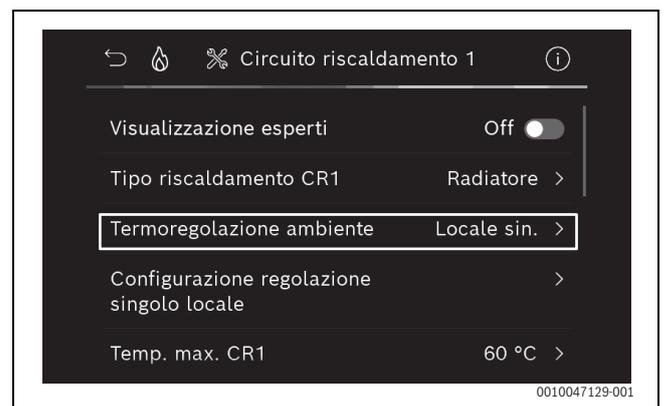
Fig. 3 Esempio di caldaia a gas a condensazione; termoregolazione indipendente radiatori
