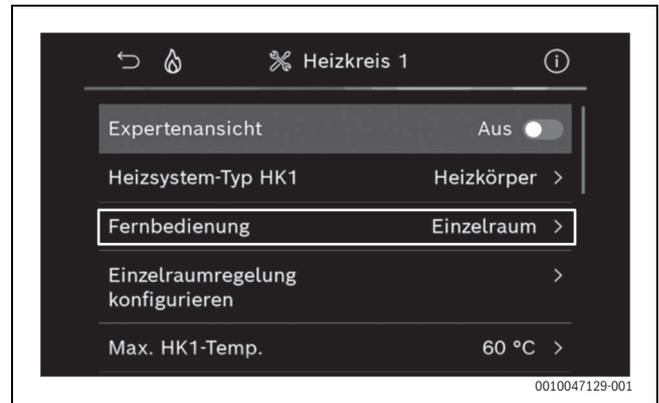
Bild 3 Beispiel Gas-Brennwertgerät; Einzelraumregelung Heizkörper
